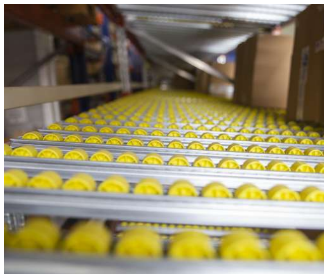
Detalle rodillos estanterías de picking dinámico
