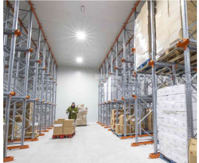
Estanterías compactas en cámara frigorífica
