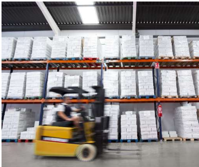
Estanterías de paletización convencional
